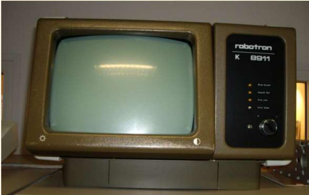
Dieses Terminal wurde hauptsächlich als Systemkonsole bzw. Datenstation für Rechner der K1600-Serie benutzt und vom **VEB Robotron Zella-Mehlis** gebaut.
