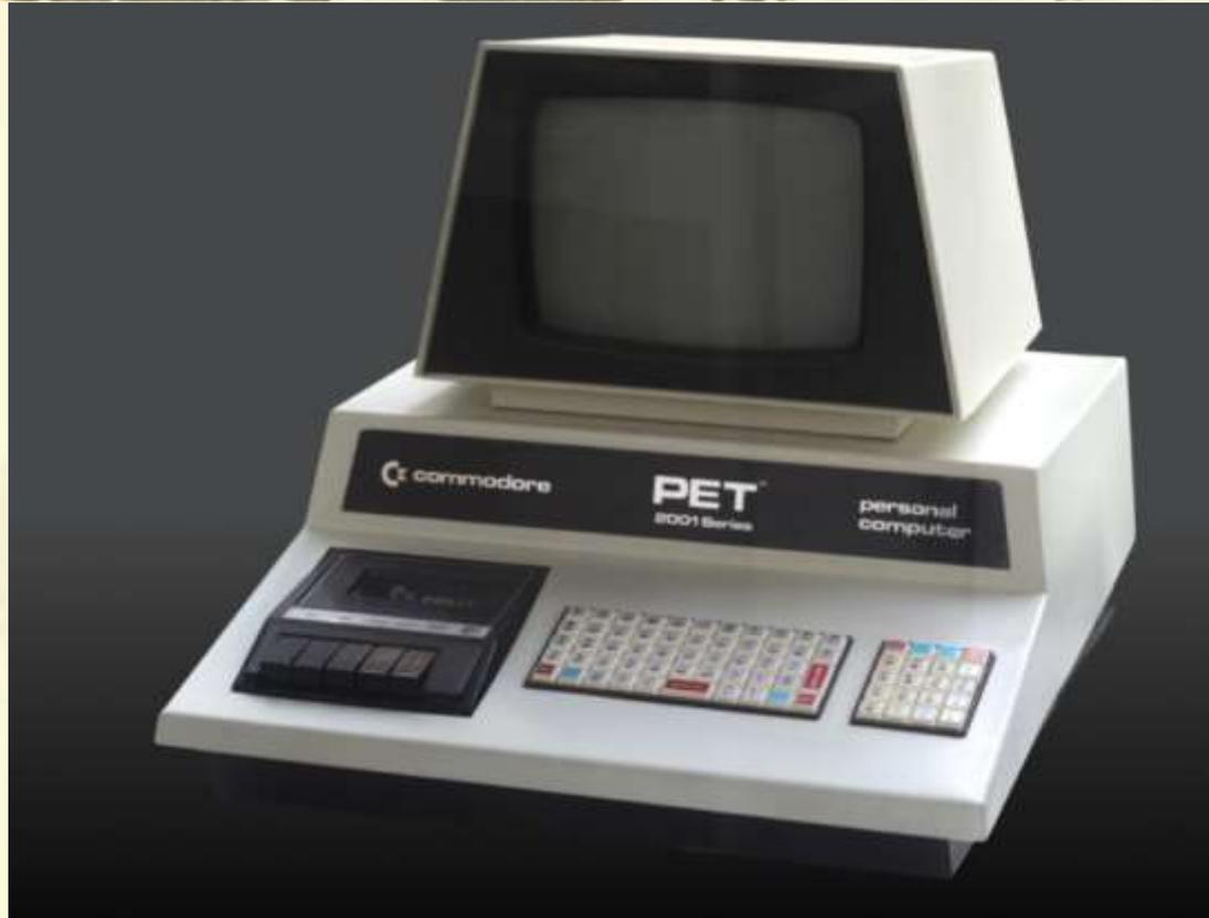
Es war der erste industriell produzierte PC in Komplettausführung (inkl. Gehäuse, Netzteil, Tastatur, Monitor und einem Massenspeicher in Form der „Datasette“). Kostenpunkt: knapp 800 Dollar.
