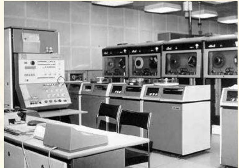
Klone im Ostblock: ESER der Reihe I waren weitgehend identisch mit dem IBM System/360. Hierzu zählten die Anlagen **R40/EC 1040** (1973 entwickelt, VEB Kombinat Robotron DDR) . 380.000 Operationen/s , Arbeitsspeicher 256 KByte, 512 KByte oder 1 MByte , Stromverbrauch ca. 15 kW.
