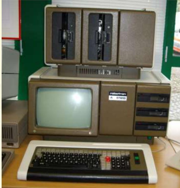
Der **A 5120** der Firma Robotron war ein **DDR-Bürocomputer** zur Text- und Datenverarbeitung. Das Gerät wurde ab dem Jahre 1982 im Volkseigenen Betrieb VEB Buchungsmaschinenwerk Karl-Marx-Stadt hergestellt. Der Preis für diesen Computer lag - abhängig von der Ausstattung - zwischen rund 27.000 und 40.000 Mark.
